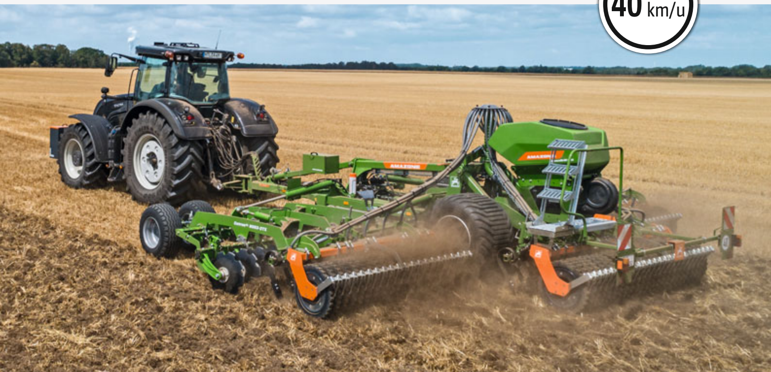
Catros XL 8003-2TX in gebruik bij stoppelbewerking
