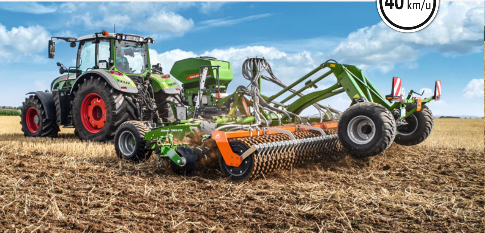
Catros + 7003-2TS in gebruik bij stoppelbewerking
