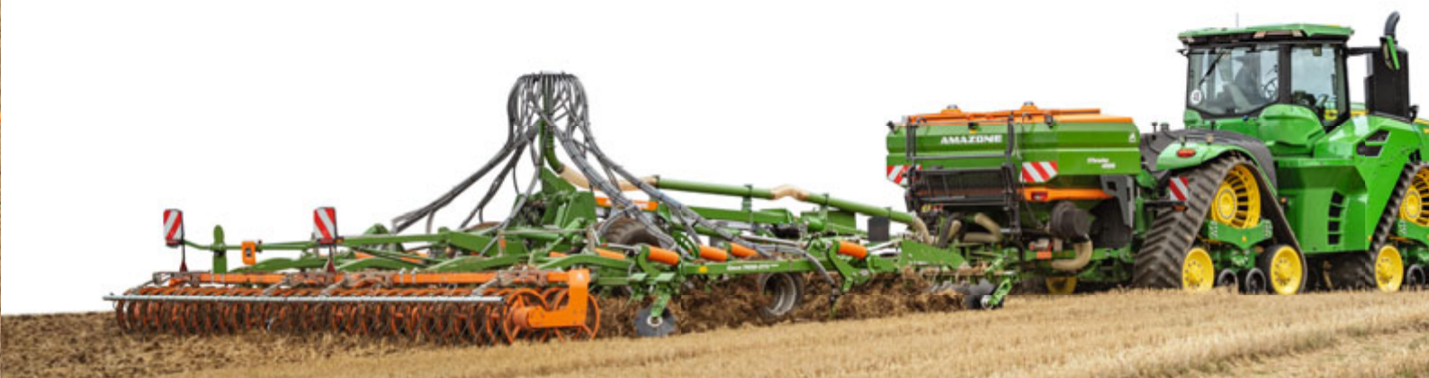
Getrokken tank XTender 4200 met een tankinhoud van 4200 l met Ceus 7000-2TX
