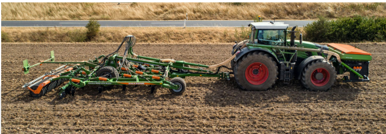
Fronttank FTender 1600 met getrokken cultivator Cenius-2TX
