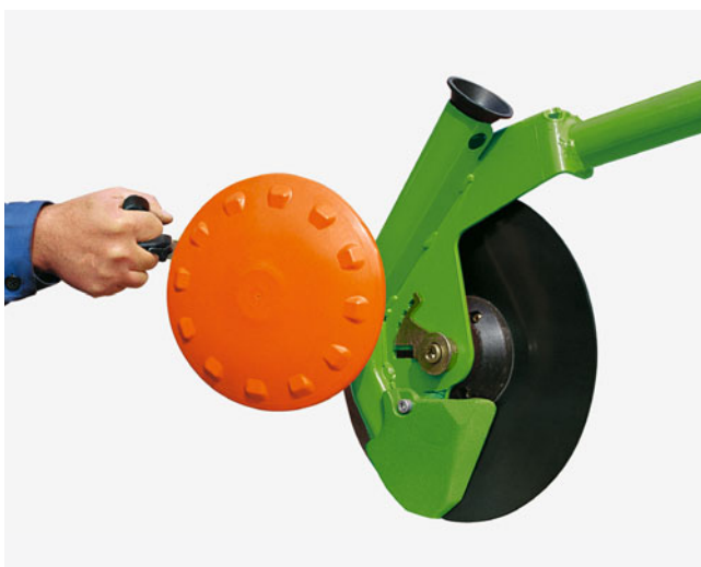
✓ RoTeC schaar (Ø 320 mm) met Control 10 dieptegeleideschijf
