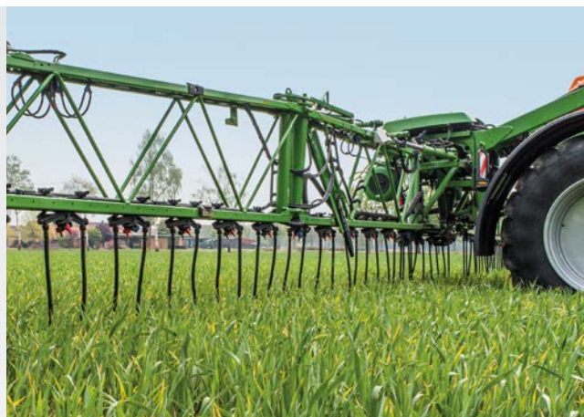
Sleepslanguitrustung met 4-voudige AmaSwitch en verplaatsingsset op de Super-L2-spruitboom
