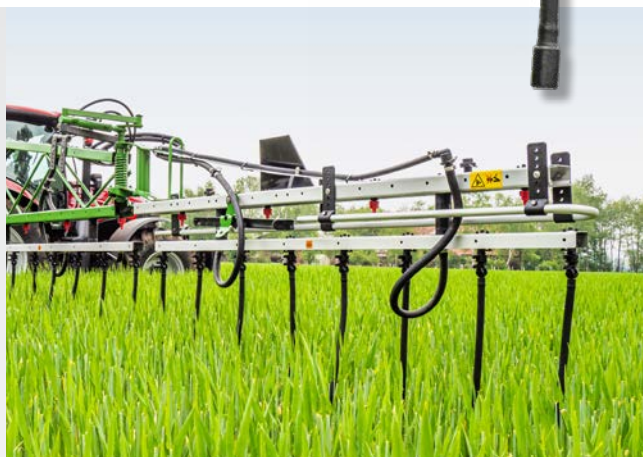
Sleepslangstelsysteem aan de Super-S2-spruitboom
