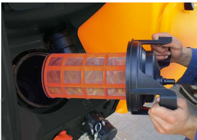
Het aanzuigfilter kan bij volle machine worden geopend en gereinigd zonder verlies van spuitvloeistof.
