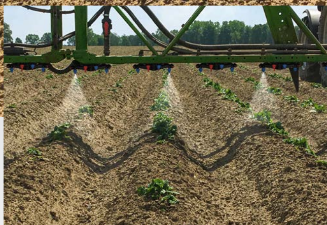
Rijen afhankelijk rijbespuiting in aardappelteelt
