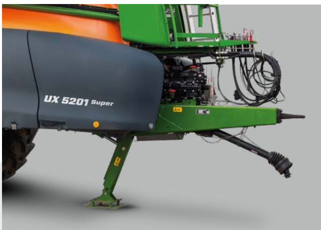
Bovenaanspanning met trekkoog en hydraulische steunpoot
