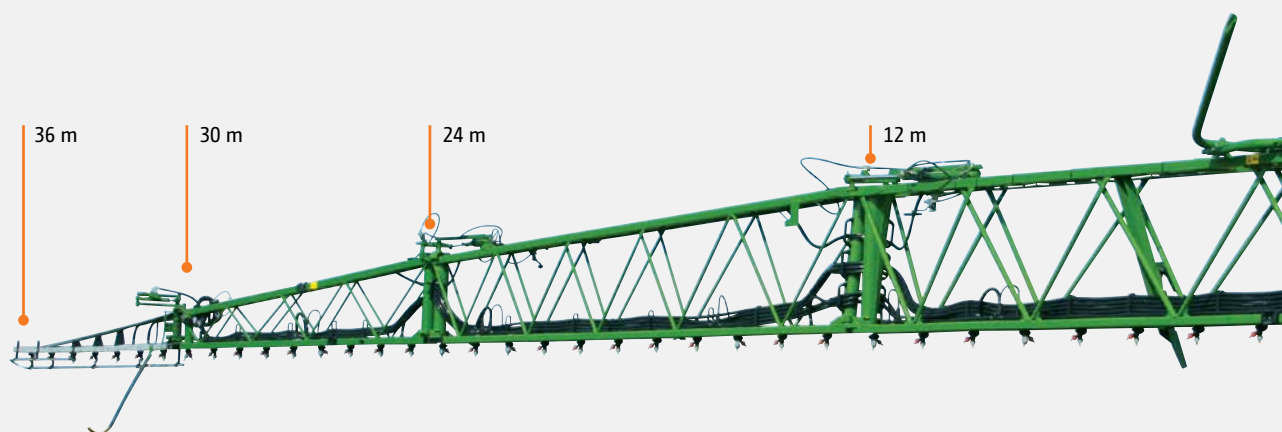
Super-L2 spuitboom met een werkbreedte van 36 m, reduceerbaar tot 30 m, 24 m en 12 m
