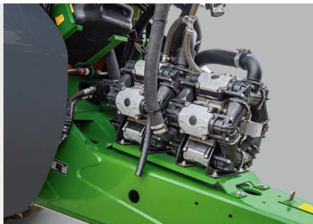
Het systeem met dubbele pompen van de UX 11201 Super kan tot 900 l/min aanzuigen
