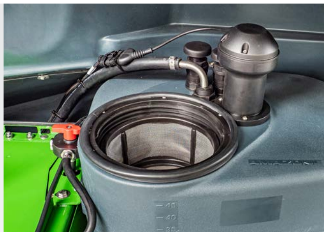
DirectInject-tank met geïntegreerde zeef voor eenvoudig en veilig vullen
